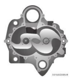
**渦卷式**:與玄尺是相同概念。經過固定漩渦外的吸入口吸入空氣。經過旋轉運動引 起壓縮空間之縮小,面向中心壓縮。壓縮空間在中心為最小,被最高限度壓縮空氣 經過中心的排氣口擠壓向外部。
