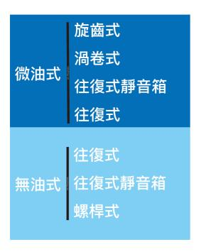
無油式:無油式的零件採用特殊自潤性材質製作,不須藉由潤滑油,即可達到壓縮部的潤滑效果。所以產生的使用空氣中不帶油份,可滿足某些行業需要無油空氣的要求。適用對象:精密工業、醫療、食品、半導體、塗裝等產業。
